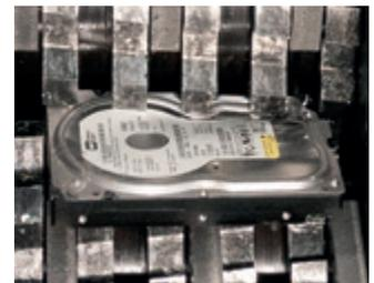
Les cylindres de coupe en acier trempé sont robustes et assurent un niveau de garantie élevé.
