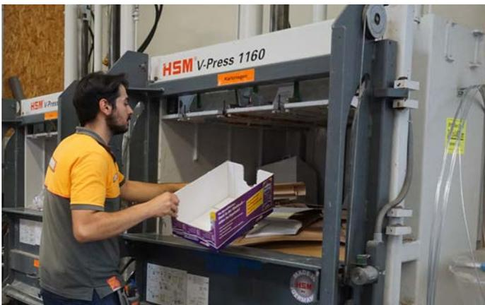
Remplissage d’une presse HSM V-Press 1160 avec des cartons qualité, un signe pour le marché de entreprises de recyclage que Hornbach prend le recyclage au sérieux. Hornbach avait des exigences supplémentaires pour les presses HSM : En considération de la présence fréquente de films plastiques mouillés dans les magasins, une protection contre la corrosion plus forte est souhaitée, des exigences spéciales étaient en outre posées pour le
